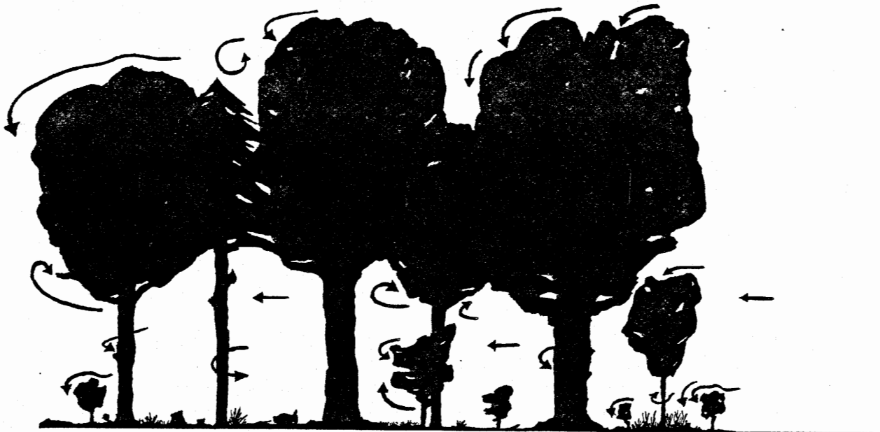
FIG. 2.26 LUCHTSTROMINGEN IN EN BIJ EEN BOS. TURBULENTIE!
